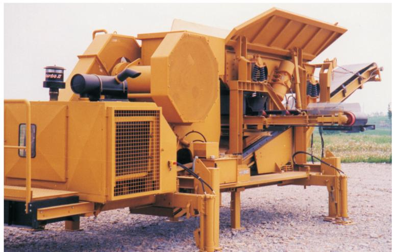
**Kufenmobile, leicht versetzbare Brechanlage mit Backenbrecher 850 x 550 mm, Typ BK 850, für Bauabbruchmaterial mit und ohne Armierung und Naturgestein.**
