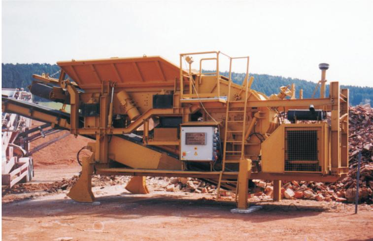
**Kufenmobile, leicht versetzbare Brechanlage mit Prallbrecher 700 mm, Typ PK 700, für Bauabbruchmaterial mit und ohne Armierung, Asphaltaufruch und mittelhartes Naturgestein.**
